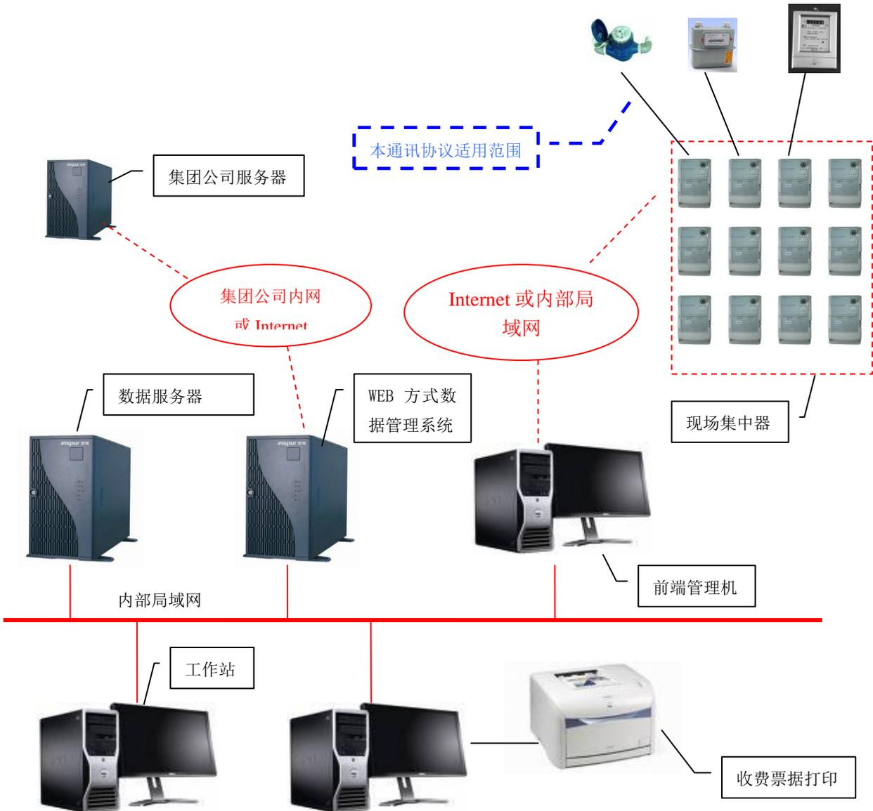
本协议为主-从模式的半双工通讯方式。集中器为主叫方，水、燃气等表计均为被叫方。每个水、燃气表计均有各自的地址编码。通讯链路的建立与解除均由主叫方来完成。
